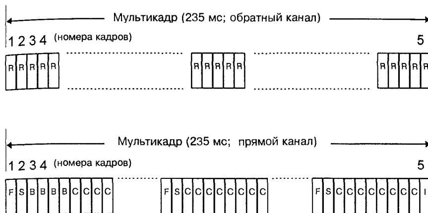
Рис.2.14. Структура мультикадра канала управления эфирного интерфейса системы GSM: R – канал RACH; F – канал FCCH; S – канал SCH; V – канал BCCH; C – канал AGCH/канал PCH; I – свободный кадр (Idle)
